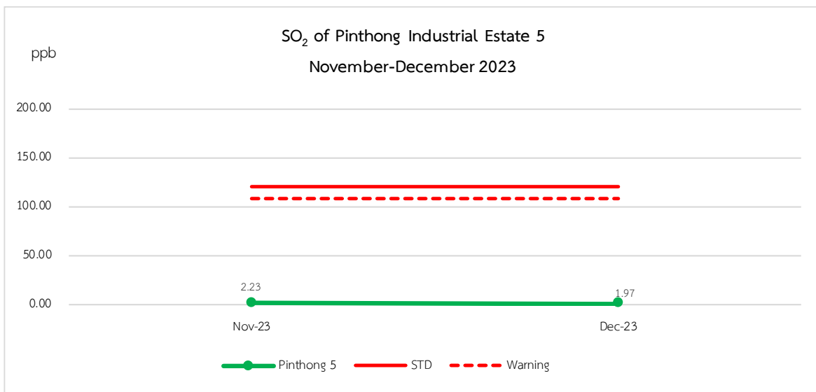
ภาพที่ 1.6 กราฟแสดงผลการตรวจวัดก๊าซซัลเฟอร์ไดออกไซด์ เฉลี่ย 24 ชั่วโมง (SO₂) ที่มีค่าสูงสุด ประจำเดือนพฤศจิกายน-ธันวาคม 2566 บริเวณนิคมอุตสาหกรรมปิ่นทอง โครงการ 5
